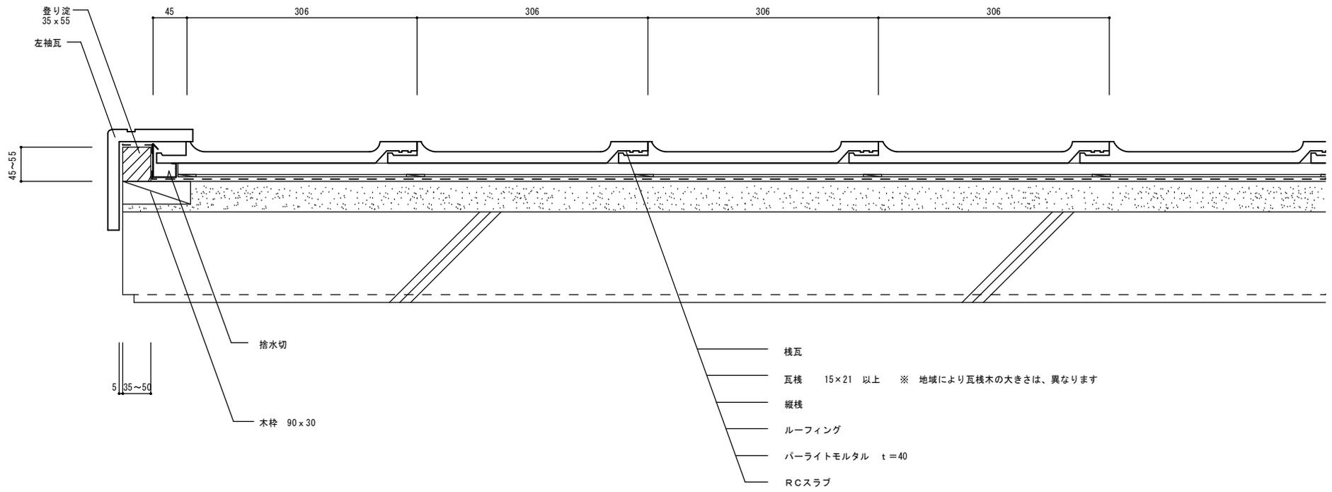
※サイディングボードを差し込む場合は、RCと袖瓦取付面の間をボードの厚み以上確保するようにしてください
