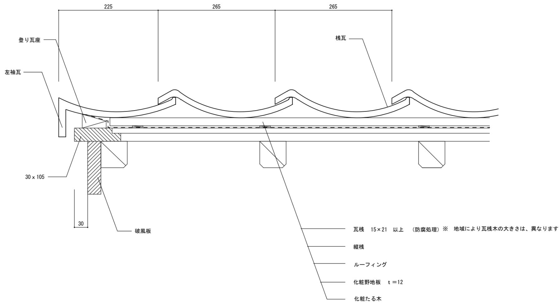
※化粧野地板の場合、釘が突き抜けないよう注意してください
